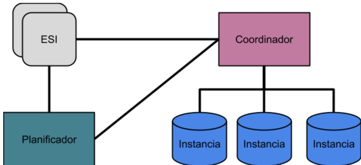
La siguiente es la arquitectura del trabajo práctico. Las líneas representan conexiones, que serán realizadas utilizando sockets TCP/IP. La conexión se llevará a cabo utilizando ips y puertos definidos en un archivo de configuración.
