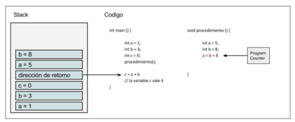
En la figura se ve claramente como al ingresar al procedimiento() el sistema operativo almacena en el stack la dirección donde debe volver al concluir.
