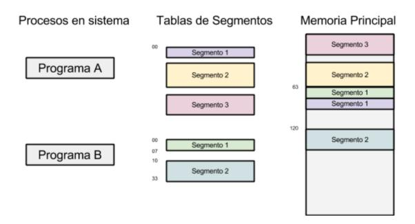
En el ejemplo de esta figura, el Proceso B consta de dos Segmentos. El Segmento 1 de 8 bytes iniciando en la posición virtual 0 y a continuación se observa el Segmento 2 de 23 bytes ubicado en la posición virtual 10.
