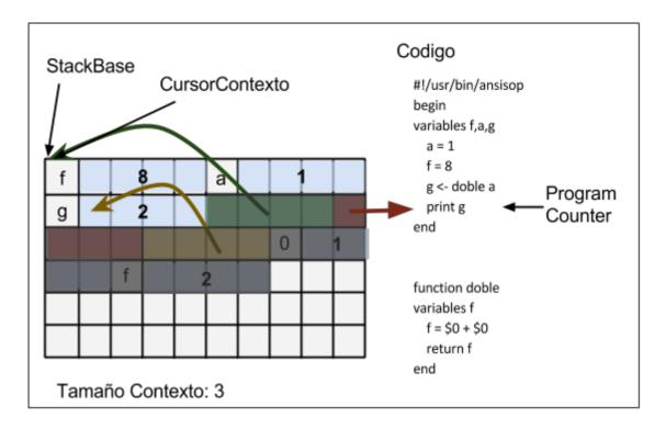
En el caso de los procedimientos, su finalización está determinada al llegar a una instrucción de end. El comportamiento será similar, con la diferencia de que no tendrá dirección donde guardar el retorno para desapilar dado que, justamente, no retorna ningún valor.
